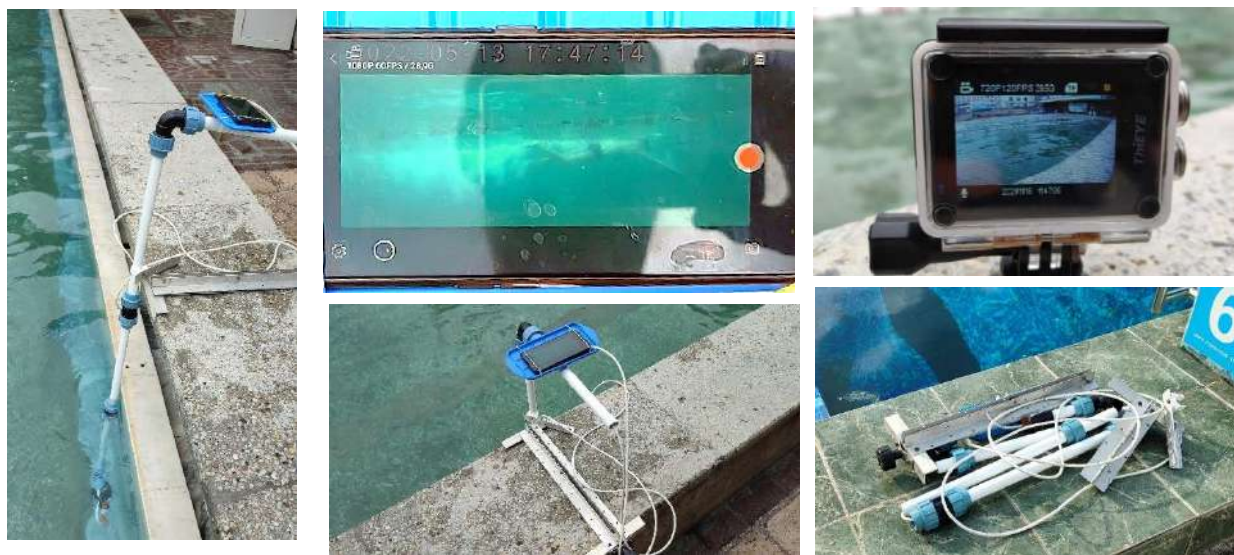
Foto. 1. Suport mobil pentru efectuarea înregistrărilor video subacvatice
